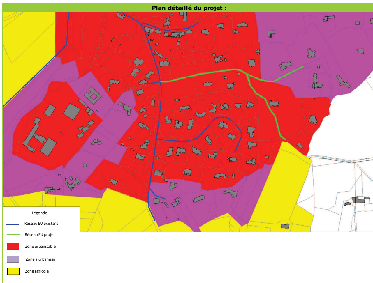
Figure 6 : Plan du raccordement du chemin de Belle Fille
